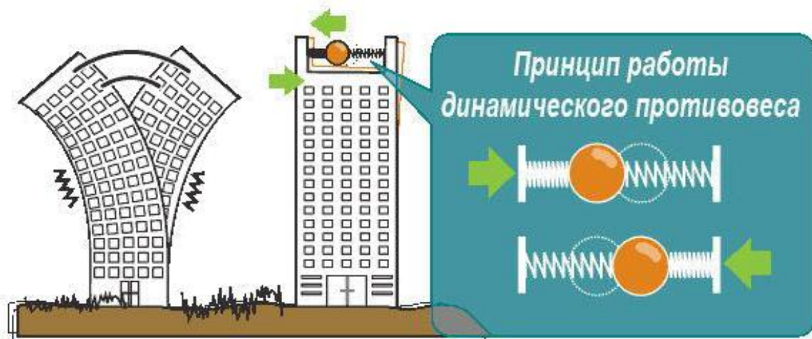
Принцип работы динамического противовеса в системе AVT
