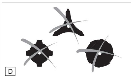
**Внимание:** Ниже перечисленный режущий инструмент может затачиваться только в специализированной мастерской, т.к. заточка от руки приводит к появлению небаланса режущего инструмента во время работы, ведущего в свою очередь к повышению уровня вибраций и повреждениям машины.
