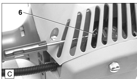
До начала регулировки стояночного газа необходимо разогреть моторную пилу в течение 3 – 5 минут.
