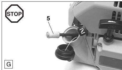
Требуемое карбюратору горючее всасывается через фетровый фильтр всасывающей головки.
