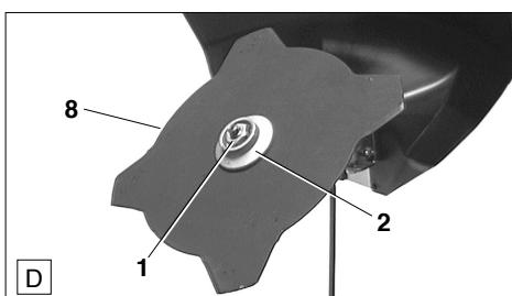
Крепящая пластина (А/1) имеет определенное монтажное положение, зависящее от применяемого режущего инструмента (нитевая головка или металлический режущий инструмент).
